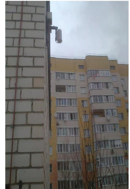
Станция контролирует **оксид углерода, диоксид азота, диоксид серы, сероводород, аммиак, формальдегид**, а также содержание **мелкодисперсной пыли**. Следует отметить, что станции похожего типа проходили тестирование в НПО «Тайфун». В результате тестирования были выявлена нестабильность показаний во времени и несовпадение с показаниями со стационарных газоанализаторов фирмы «ОПТЭК».
