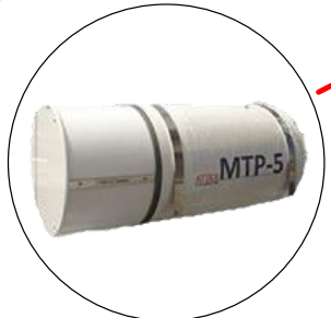
Профилемер метеорологический температурный МТР-5
