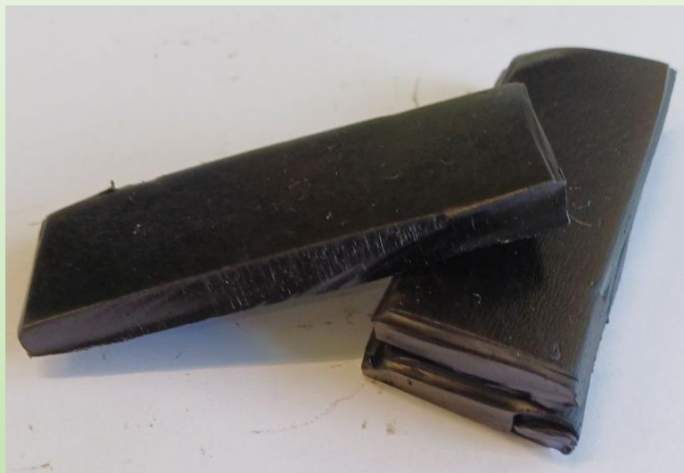
Товарный гудрон (битум после термической переработки кислого гудрона)
